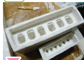
工程3 原料（ポリレジン）をシリコン型に流し込み
