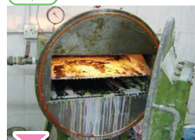
工程5 型から製品を取り出して、次工程でバリを取り除く
